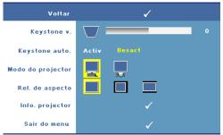
**KEYSTONE V.**—Permite-lhe ajustar a distorção da imagem provocada pela inclinação do projector.
